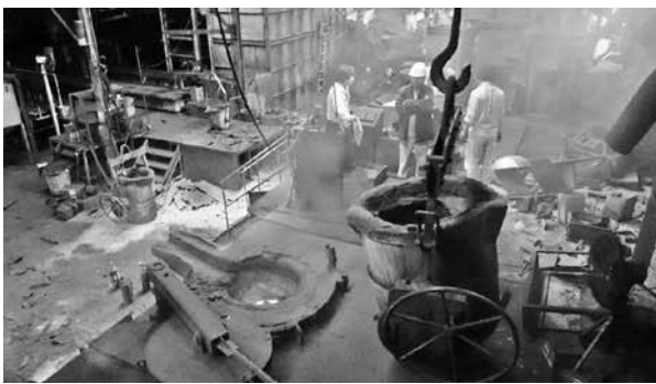
震災直後の工場内、焼け焦げた溶解炉
