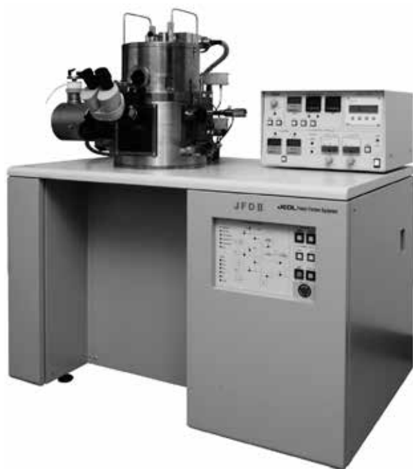
図4. 凍結試料作製装置概観
