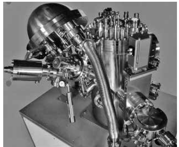
アルバック・ファイ(ULVAC-PHI, Inc) 社製 PHI 5000 VersaProbe XPS: X-Ray Photoelectron Spectroscopy ESCA: Electron Spectroscopy for Chemical Analysis
