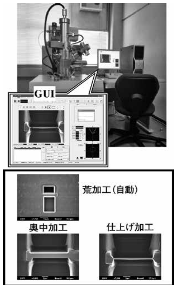
図3. 薄膜試料作成装置の概観及び加工例
