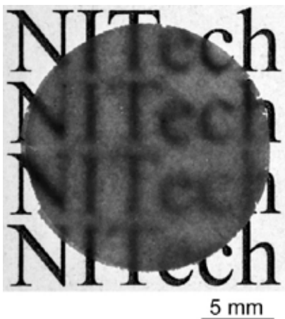
作製した結晶配向セラミックス（透過光）
