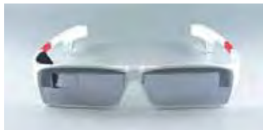
写真1.音を可視化した画像等を表示する 透過式の眼鏡型情報端末「ヘッド マウントディスプレイ（HMD）」
