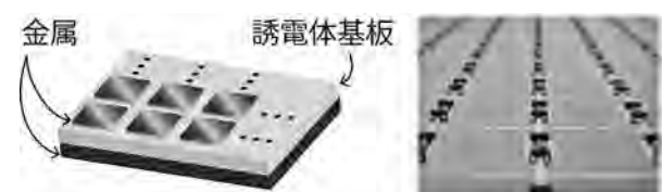
図2. (左) メタマテリアルと (右) 回路素子を統合した例
