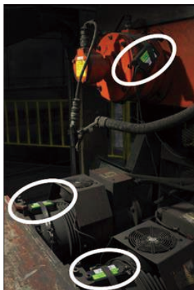
写真③ 鋳造ラインの機械に取り付けた自作の無線センサー子機（丸印内）
