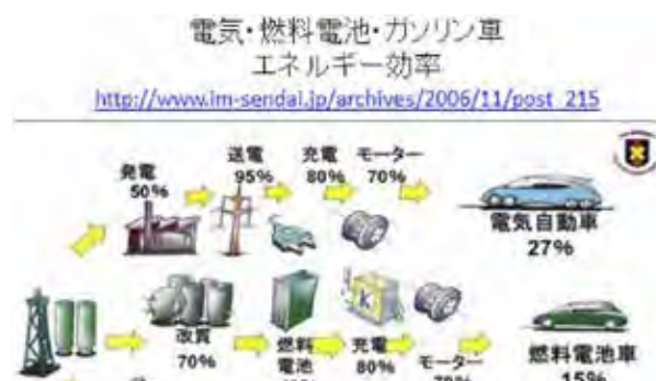
図8. 電気・燃料電池・ガソリン車の エネルギー効率比較
