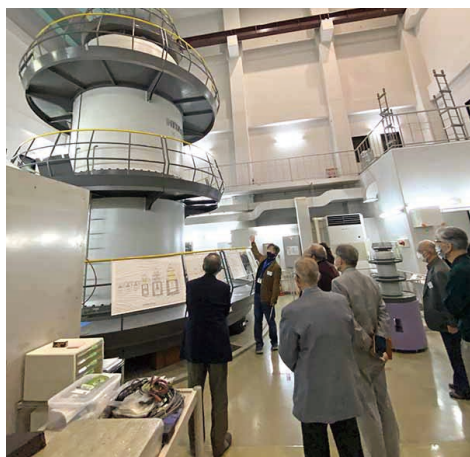
写真-1 超高压電子線発生装置を内蔵する高圧タンク
