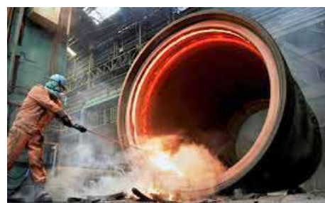
図6. 鑄鉄管遠心力鑄造(1953年～)
