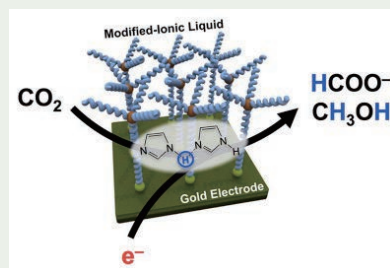
図7. イミダゾール分子を内包したイオン液体修飾電極による二酸化炭素還元反応の模式図。印可する電によりギ酸やメタノールが低過電圧で生成します。
