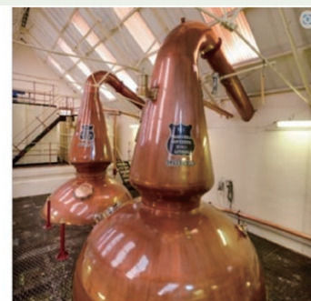
(図-4) ポットスチル https://mimai-whisky-piano.com/pot-still/ より
